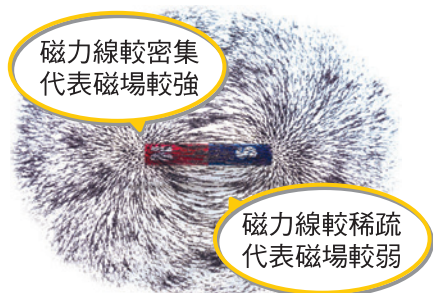
▲圖 (a) 利用鐵粉觀察磁力線
